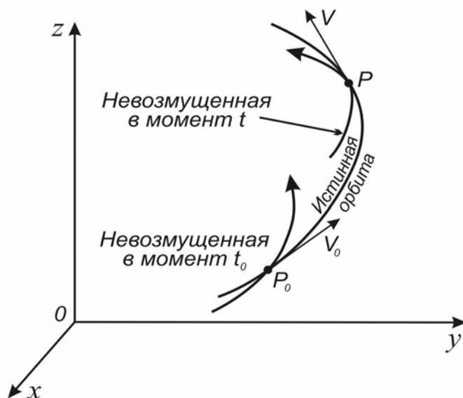
Рис. 2. Траектории кеплеровского невозмущенного движения и оскулирующая орбита возмущенного движения (по Г.Н. Дубошину, 1975).
